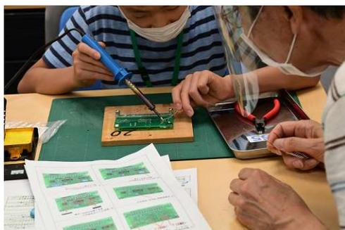
図 1 光オルゴールの回路基板製作
