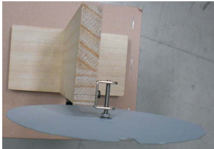
図 9: ルーレットの回転軸。ネジが空回りする構造。回転板とナットの上にワッシャーがはさまっている。
