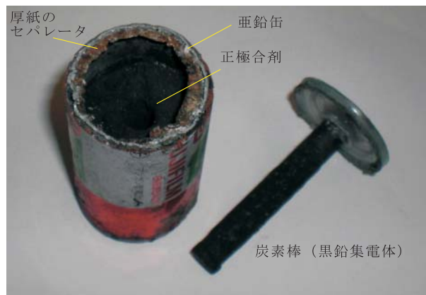
図 1: マンガン電池の内部。
